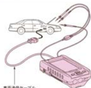
車両通信ケーブル
