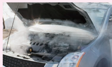
冷却不良によるオーバーヒート
