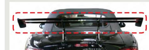
基準 側面への翼形状を有していないこと。確実に取り付けられていること。鋭い突起がないこと。その付近の最外側、最後端ならないこと。など。
