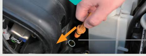
④もう一度抜いてオイルの量がオイル・レベル・ゲージの規定の範囲内(HとLの間)にあるかを確認します。
