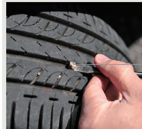
①著しい亀裂や損傷がないかをタイヤの全周にわたり点検します。また、釘、石、その他の異物が刺さったり、かみ込んだりしているかを点検します。
