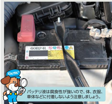
バッテリの液量が規定の範囲 (UPPERとLOWERの間) にあるかを車両を揺らすなどして点検します。
