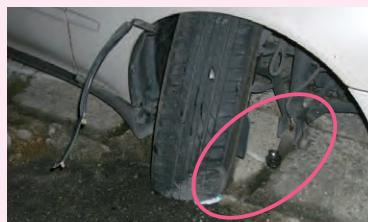
破損した前輪と車体をつなぐ装置
