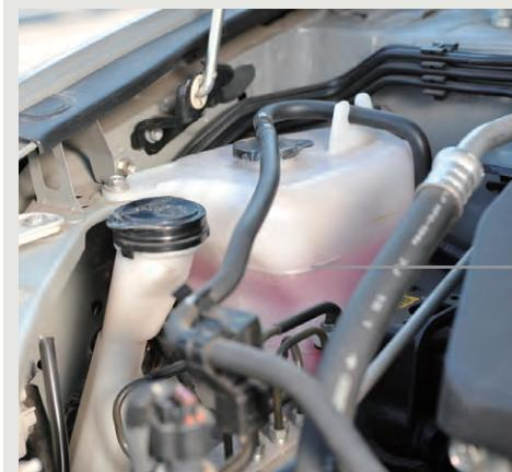
ラジエータ・リザーバ・タンク内の冷却水の量が規定の範囲 (FULLとLOWの間) にあるかを点検します。
