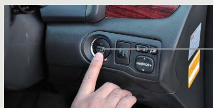
エンジンが速やかに始動し、スムーズに回転するかを点検します。また、エンジン始動時およびアイドリング状態で、異音がないかを点検します。
