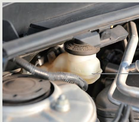
ブレーキ・リザーバ・タンク内の液量が規定の範囲 (MAXとMINの間) にあるかを点検します。
