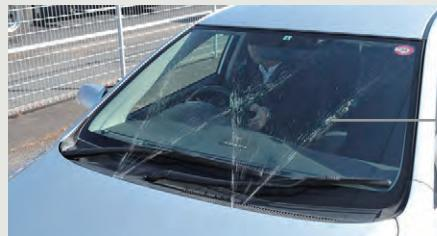
ウィンド・ウォッシャ液の噴射の向きおよび高さが適当かを点検します。
