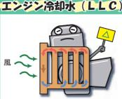
腐食防止および凍結防止性能が低下。
