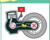
ベルト切れにより走行不能および 伸びにより変速不良。
