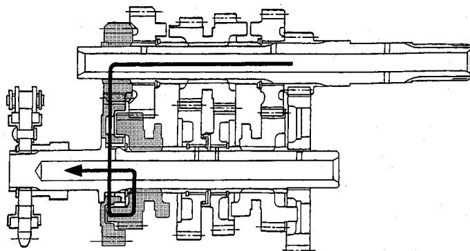
[No. 13] プライマリ・キック式の始動装置で、キック・スタータ・ペダルが踏み込まれたときに最初にペダルの回転力が伝わる部品として、適切なものは次のうちどれか。
