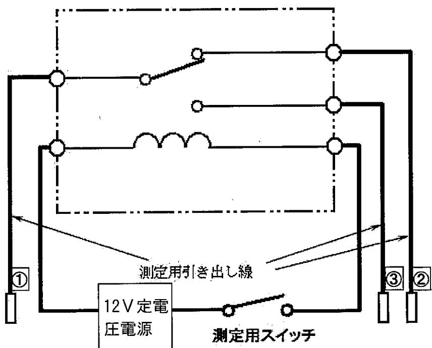
※リレー回路の導通点検は、測定用引き出し線による端子を使用して行いなさい。
