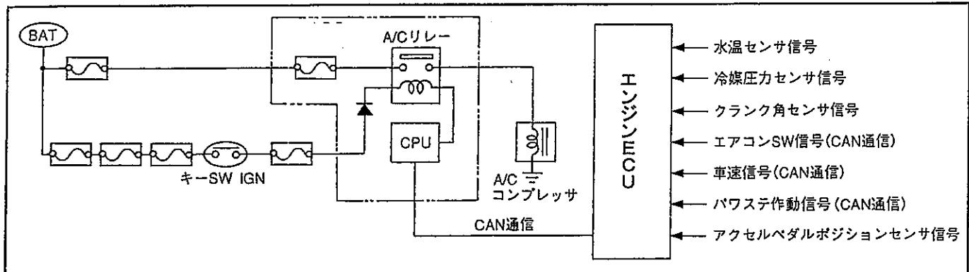
通常はエアコン・スイッチON信号でエアコン・リレーがONし、エアコン・スイッチOFFでエアコン・リレーはOFFするが、下記条件時は、エアコン・スイッチがONでもエアコン・リレーをOFFにし、エアコン・コンプレッサを停止する。
