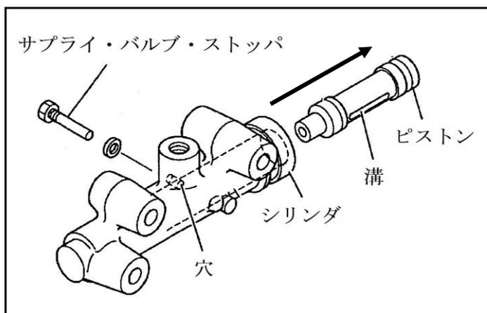
サプライ・バルブ・ストップを外すと、ピストンが飛び出るため、指でピストンを押さえた状態で適切な工具を用いて取り外すこと。
