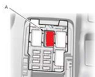
室内のヒューズボックス
