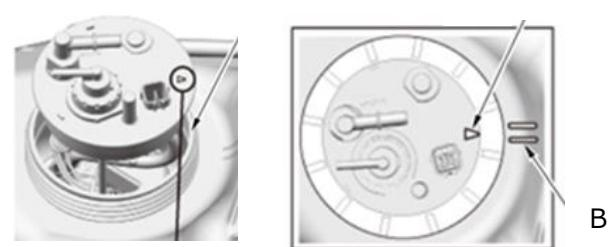
14. 新品のロックナットのマーク(A)とタンク側のネジの始まりを(B)合わせて、ロックナットを手でねじ込む。
